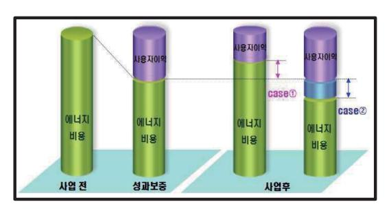
[그림 4] 성과보증방식 시스템
